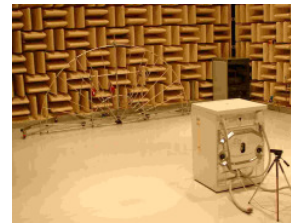
Blick auf das Halbkreisarray und die auf Quellen zu untersuchende Maschine
