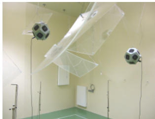
Anordnung der Diffusoren, der Lautsprecher und der Absorber im Messraum
