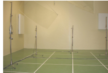
Anordnung der Mikrofone für Messungen nach ISO 3741
