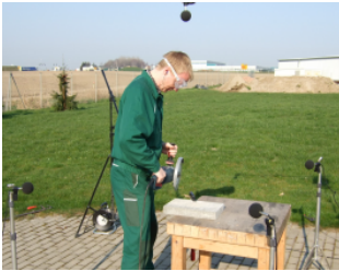
Geräuschmessung unter kundenspezifischen Anforderungen (Trennen von Beton)
