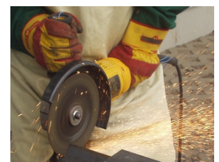
Schwingungsmessung unter kundenspezifischen Anforderungen (Trennen von Stahl)
