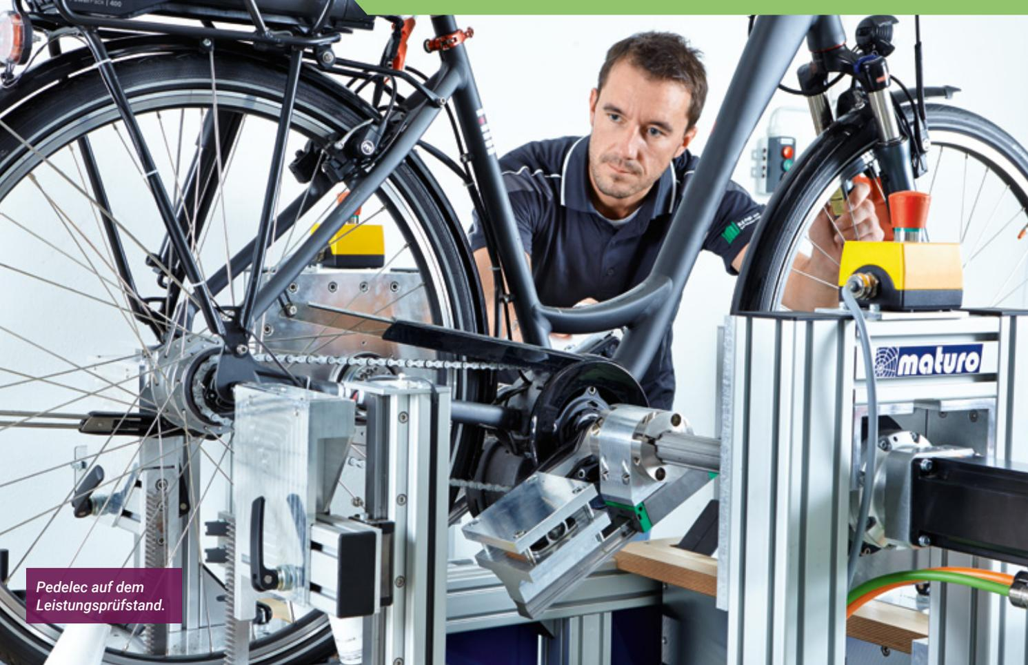
Pedelec auf dem Leistungsprüfstand.
